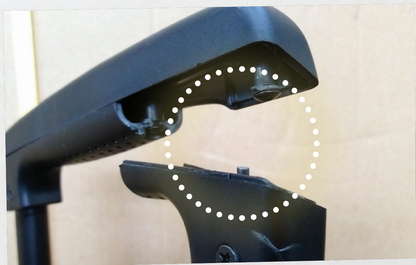
圖二：有樣本的拉桿上下搖晃數千次時，手柄斷裂。
