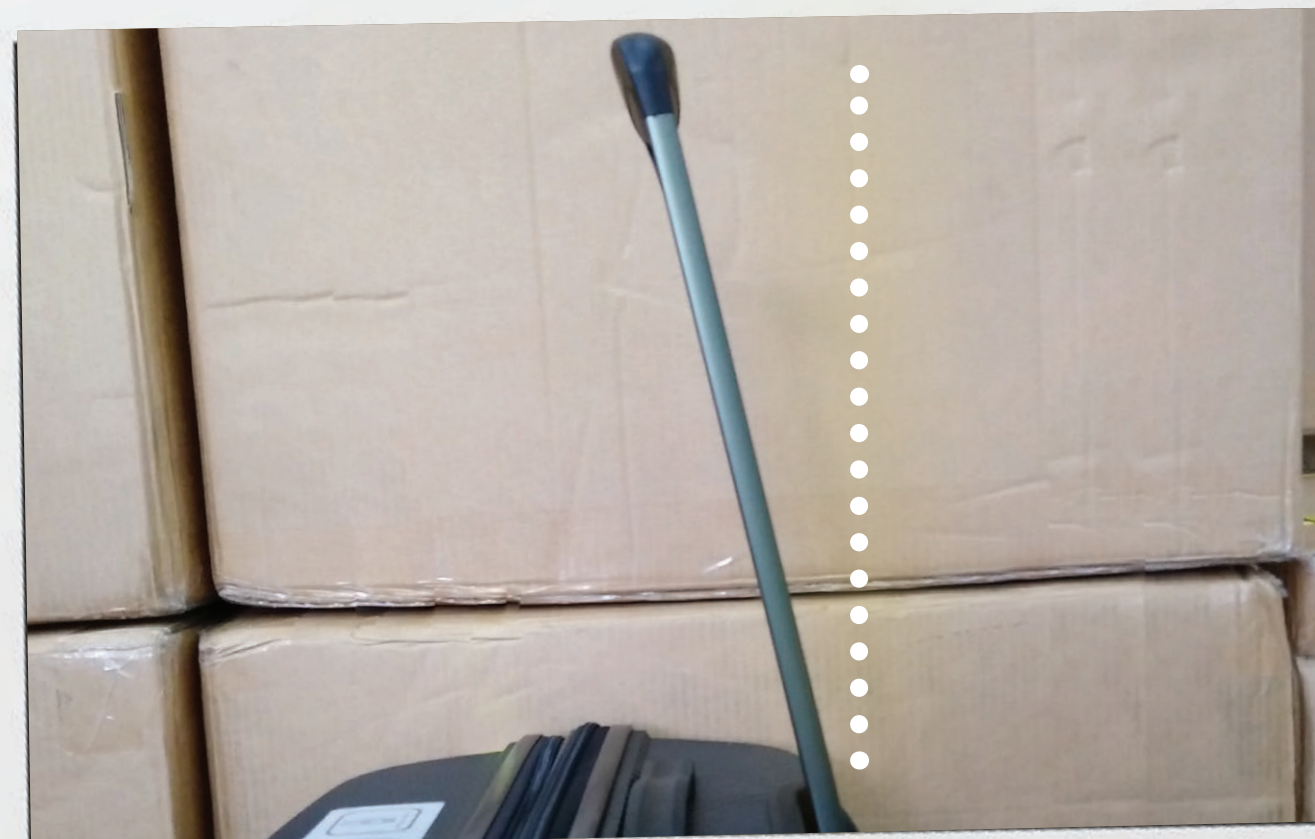
圖五：有樣本於進行樓梯測試時，拉桿彎曲變形，以致未能正常伸縮。
