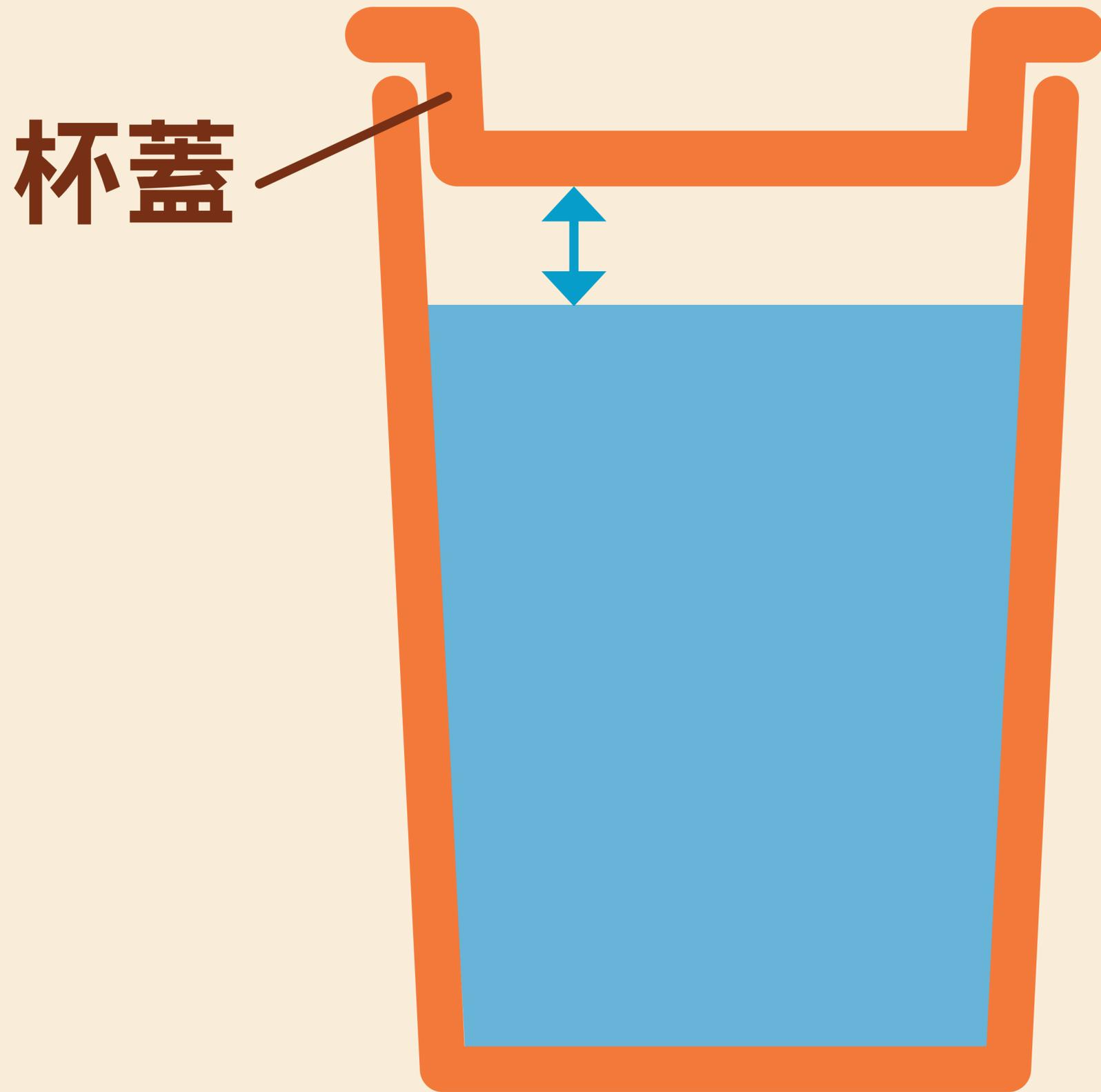
實驗室參考歐洲標準方法量度樣本的公稱容量，意思指量度關上杯蓋後，杯蓋插入杯內最低位置以下 10 毫米水平的容量。
