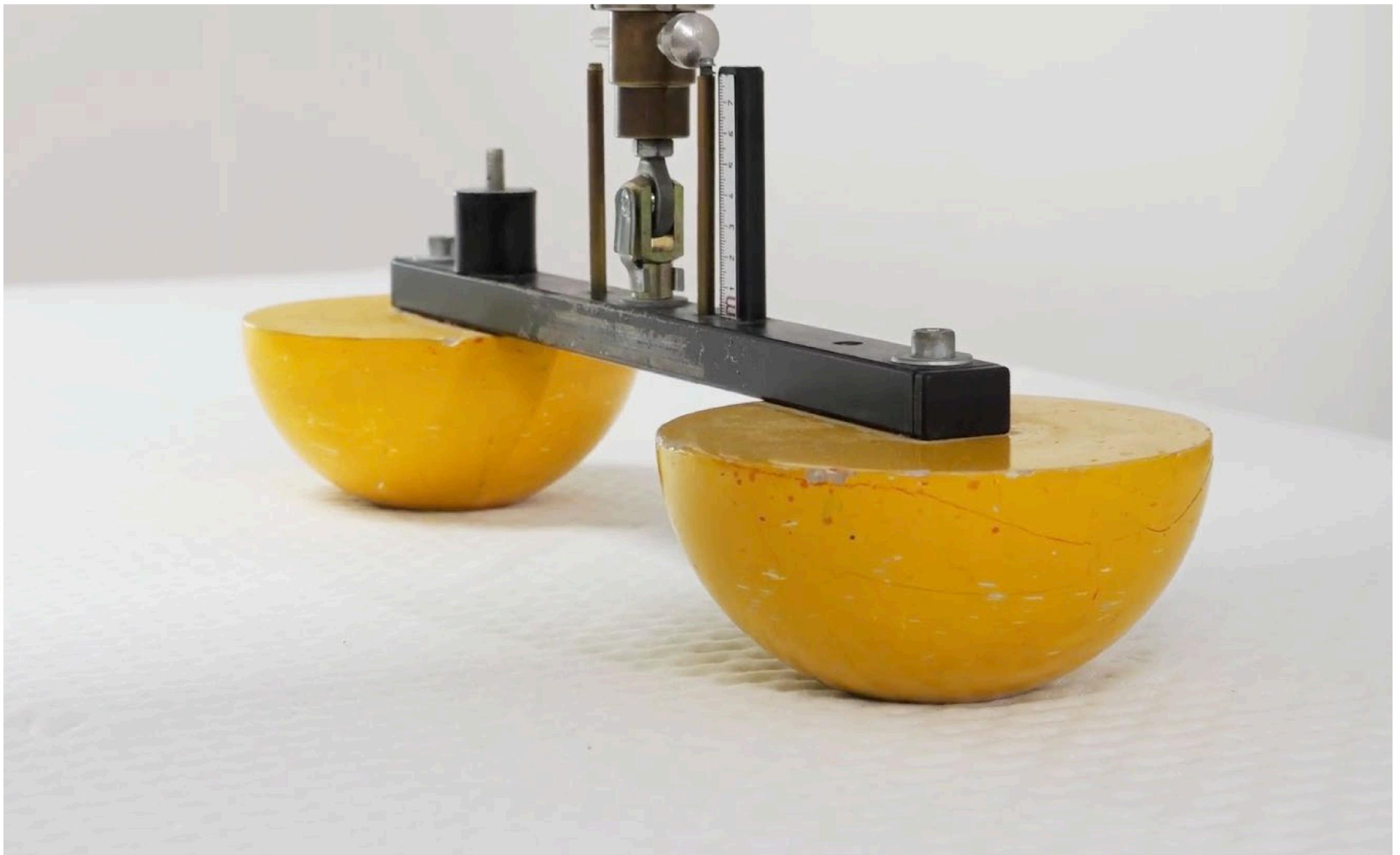
**圖一： 量度樣本於受壓兩點的中間位置和沒有受壓時的高度差異，以評估樣本的點彈性。**
